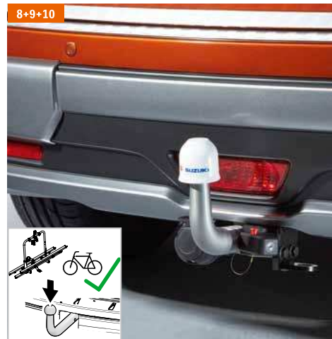
8 | Демонтируемый фаркоп. 6 Макс. допустимая вертикальная нагрузка на крюк фаркопа 75 кг. Электрический разъем для подключения фонарей прицепа заказывается отдельно. 72901-54P00-000
